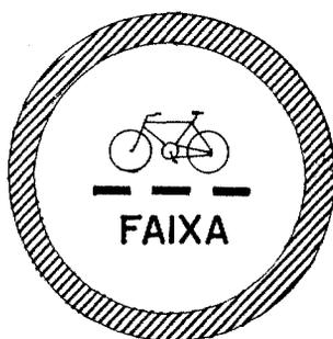
FIGURA 23 - PLACA R-33: FAIXA EXCLUSIVA PARA BICICLOS LEVES
