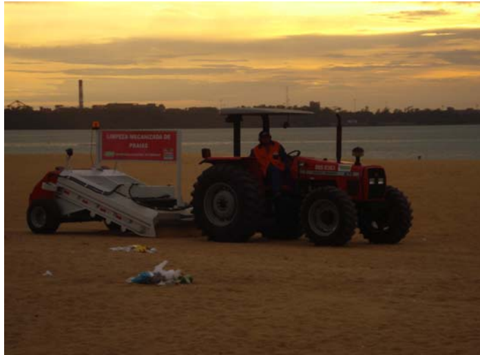
Figura 26: Limpeza mecanizada de praias
