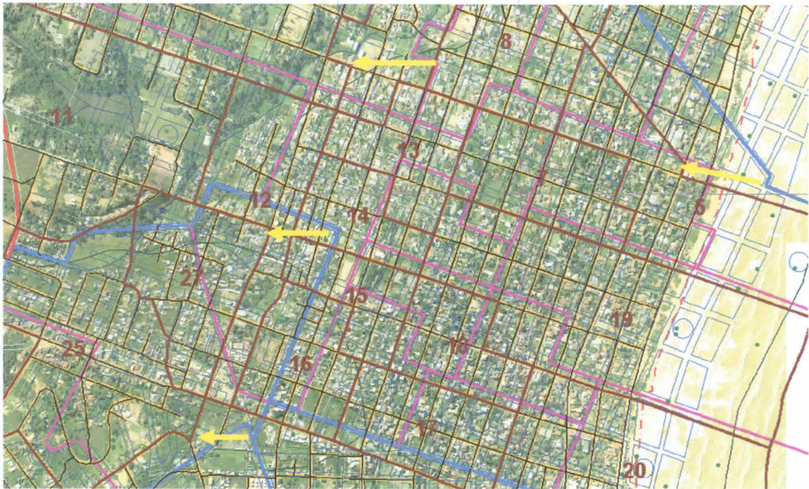
Figura 02 – Deslocamentos do arquivo IBGE dos Setores Censitários 2007 em relação à base cartográfica na escala 1:5.000.
