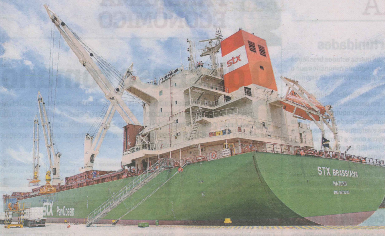
NAVIO BRASSIANA pode transportar celulose, café, rochas, produtos de madeira e fertilizantes. Embarcação tem capacidade para 54 mil toneladas
