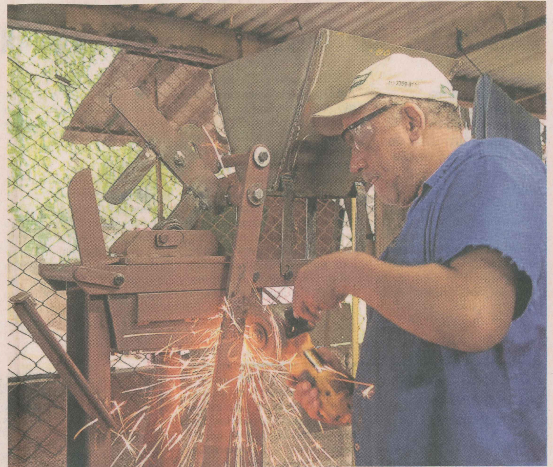
PRODUÇÃO. Cada prensa manual custa cerca de R$ 4 mil e é capaz de fabricar até 800 tijolos por dia
