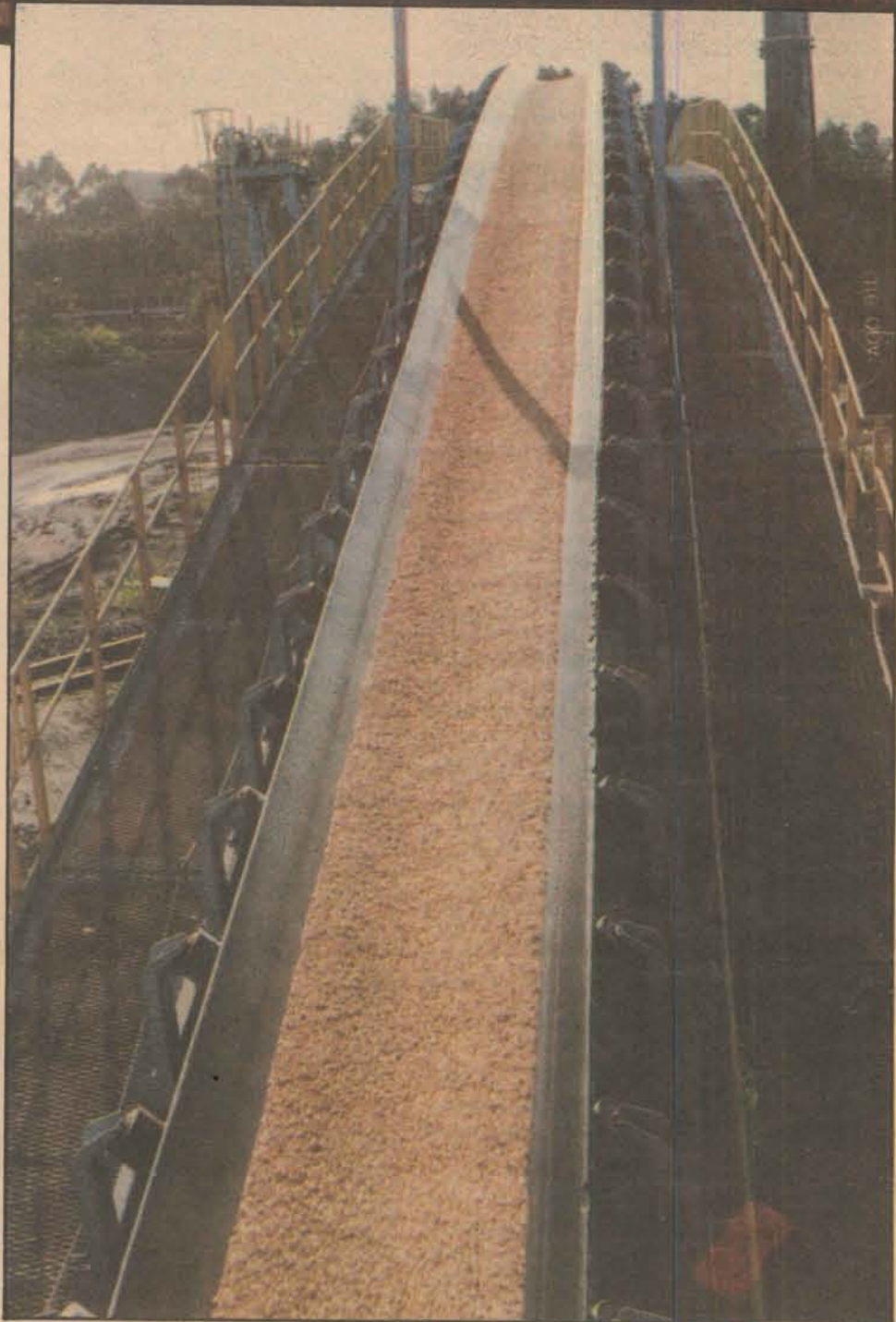
O embarque por correia transportadora uniu o vagão aos porões do navio
