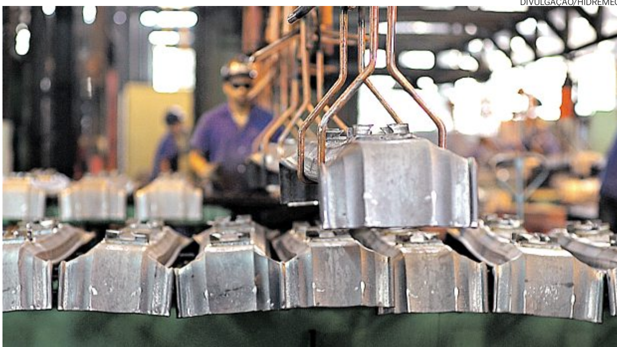
Especializada na produção de dormentes de aço, Hidremec pode produzir 400 mil unidades por ano
