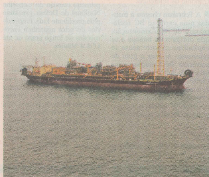
CAPACIDADE. A plataforma tem capacidade para produzir 100 mil barris por dia e 3,5 milhões de m 3 de gás por dia
