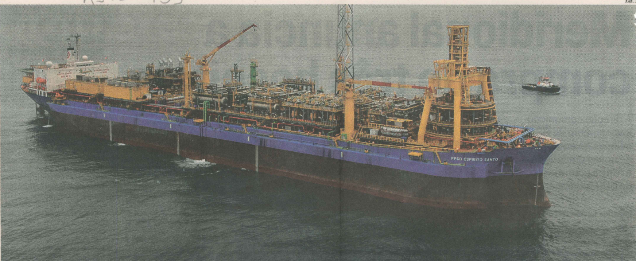
O NAVIO-plataforma FPSO Espírito Santo tem mais de 330 metros de comprimento e capacidade de processar por dia 100 mil barris de petróleo e 1,42 milhão de metros cúbicos de gás natural
