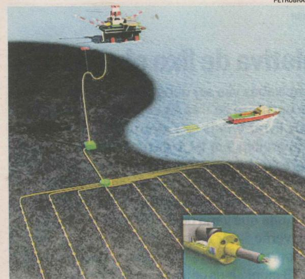
MODELO esquemático do sistema sísmico permanente utilizado no Campo de Valhall
