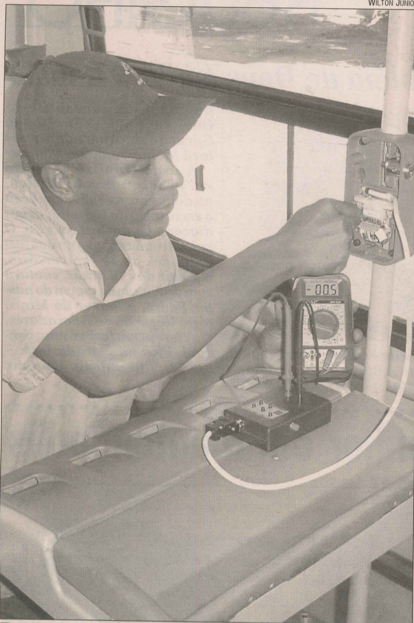
Funcionário instala catraca eletrônica em ônibus
