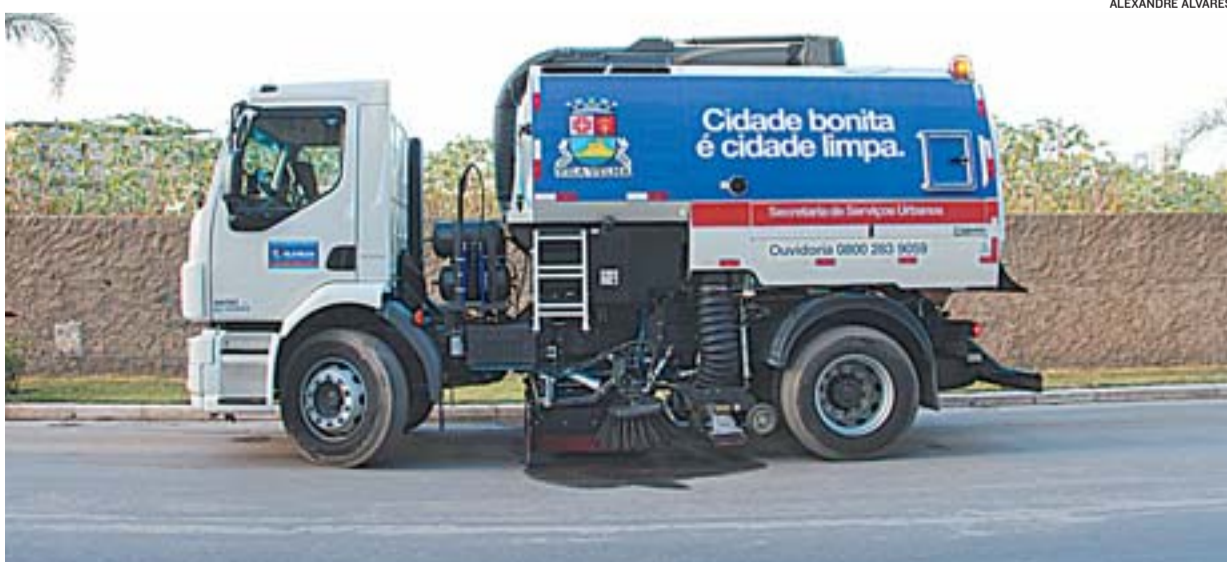
VASSOURA MECANIZADA percorre, em média, 58 quilômetros por noite, varrendo, aspirando e jogando água
