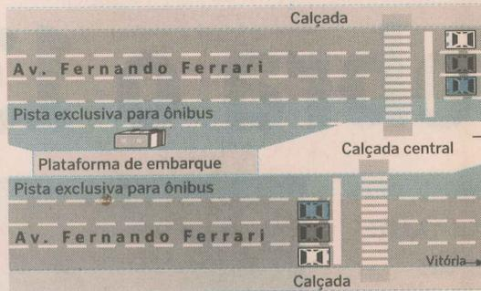
O canteiro central, com três metros de largura, dividirá a via, que passará a ter 30 metros de largura contando com as duas calçadas.
