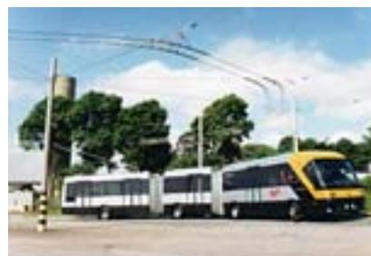
ÔNIBUS é ligado a cabos elétricos
