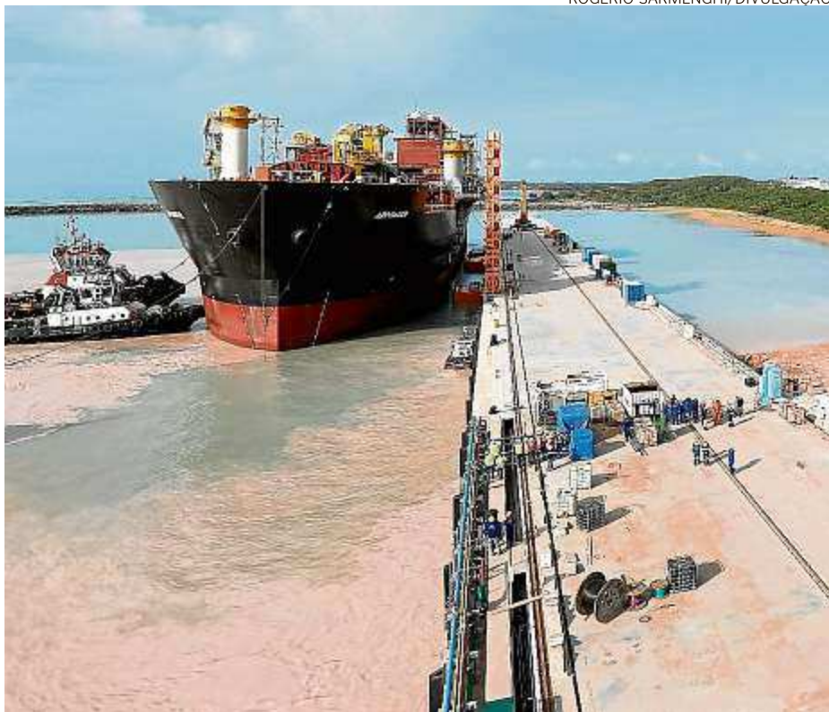
Embarcação possui 203 metros de comprimento e 40 metros de largura
