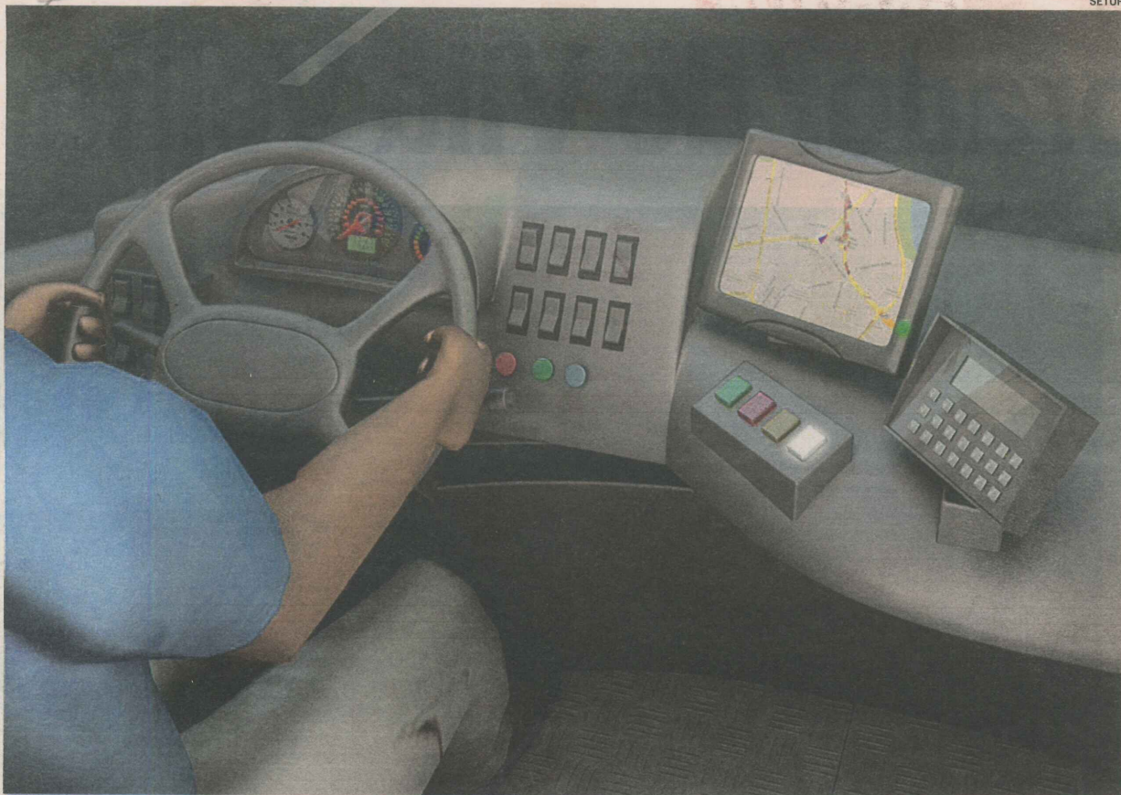
PROJEÇÃO mostra ônibus adaptado com computador de bordo e botão que será acionado em caso de emergência
