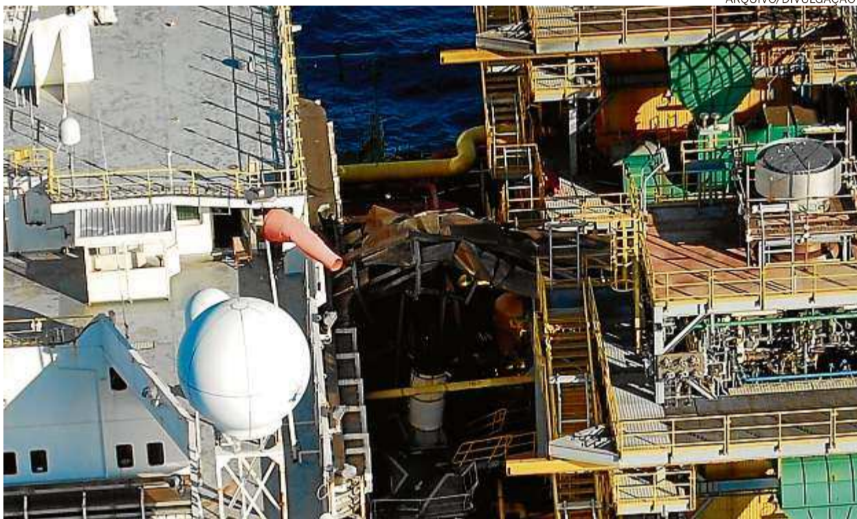
Ferro retorcido indica o local onde ocorreu a explosão no navio-plataforma FPSO Cidade de São Mateus
